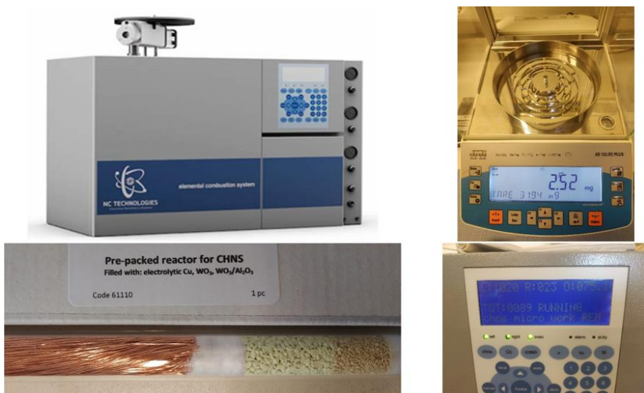
2.26. attēls. Costech ECS 4010 elementanalizators un to komponentes
