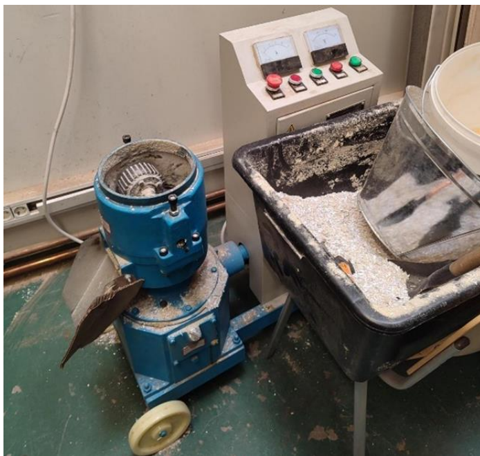
2.1. attēls. Pētījumā izmantotais granulators
