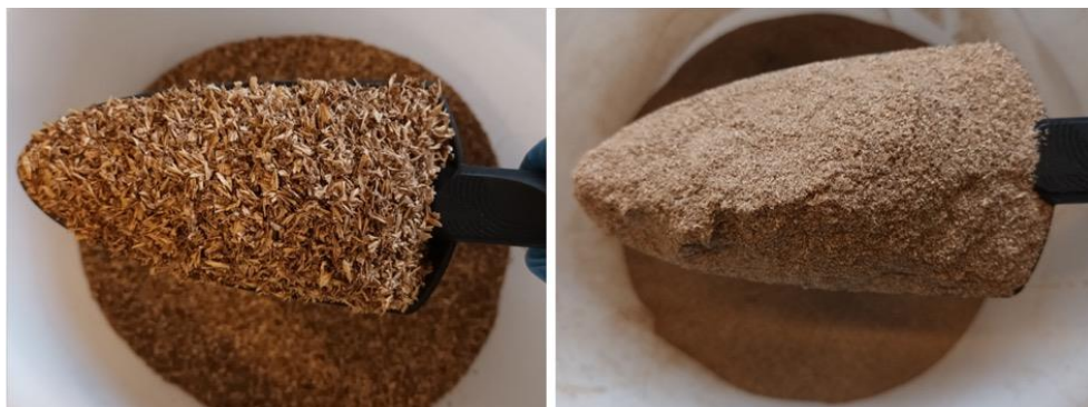
2.25. attēls. BSG pirms (pa kreisi) un pēc (pa labi) malšanas
