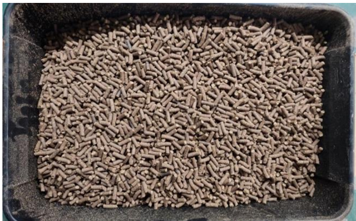
2.2. attēls. Veidoto granulu paraugs (drabiņu un kokskaidu maisījuma granulas)
