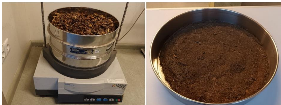
2.17. attēls. L sijāšanas process un izsijātais materiāls
