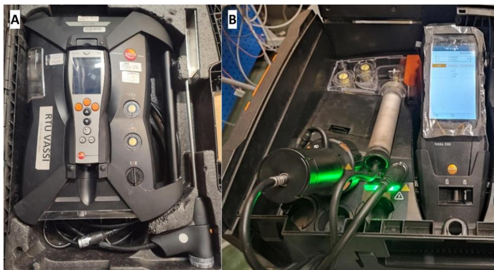
2.40. attēls. Testos izmantotais dūmgāzu analizators (A) un cieto daļiņu mērītājs (B)
