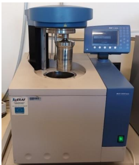
2.28. attēls. Kalorimetrs IKA C2000 ar pievienotu kalorimetrisko bumbu
