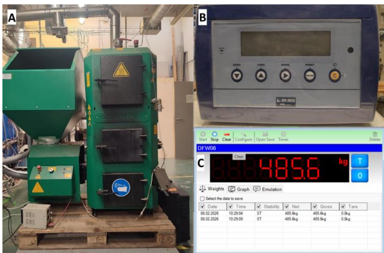
2.35. attēls. Izmantotā granulu katla vizuālais izskats (A), svaru displejs (B) un datu nolasīšanas programmas interfeiss no svaru displeja (C)
