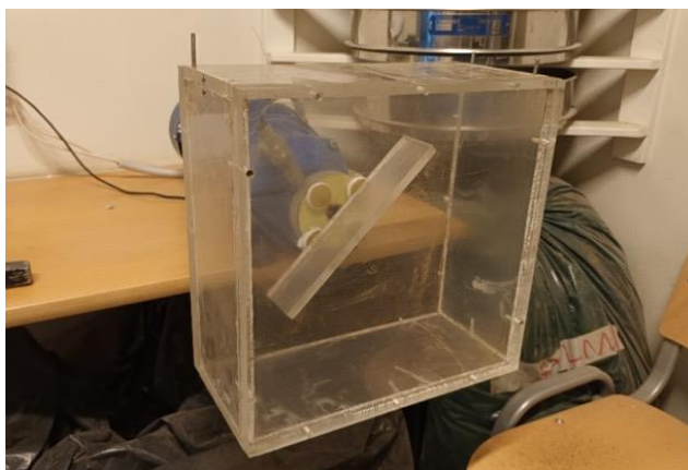
2.31. attēls. Standartam atbilstoša mehāniskās izturības noteikšanas stends
